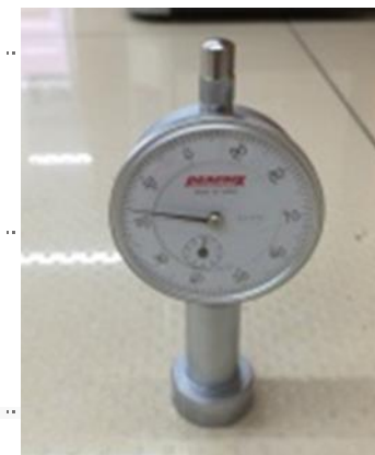
深さゲージでドット高さの測定が可能
