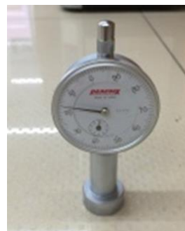
深さゲージでドット 高さの測定
